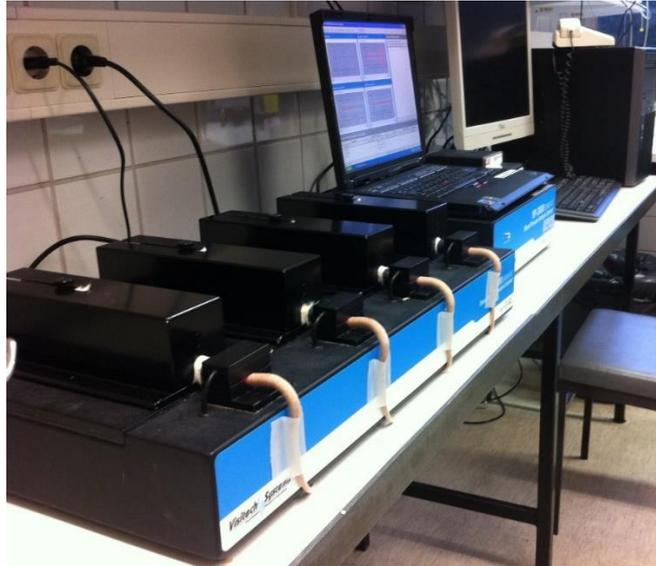
Abb. 16 periphere Blutdruckmessung am Rattenschwanz, „Tailcuff“-methode: Ratten in Versuchstierhaltern während der Messung
