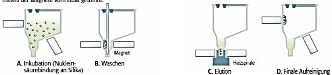
Abbildung 4: Extraktionsprinzip mit NucliSENS easyMAG (Familie bioMérieux, Marcy-l'Étoile, Frankreich)
