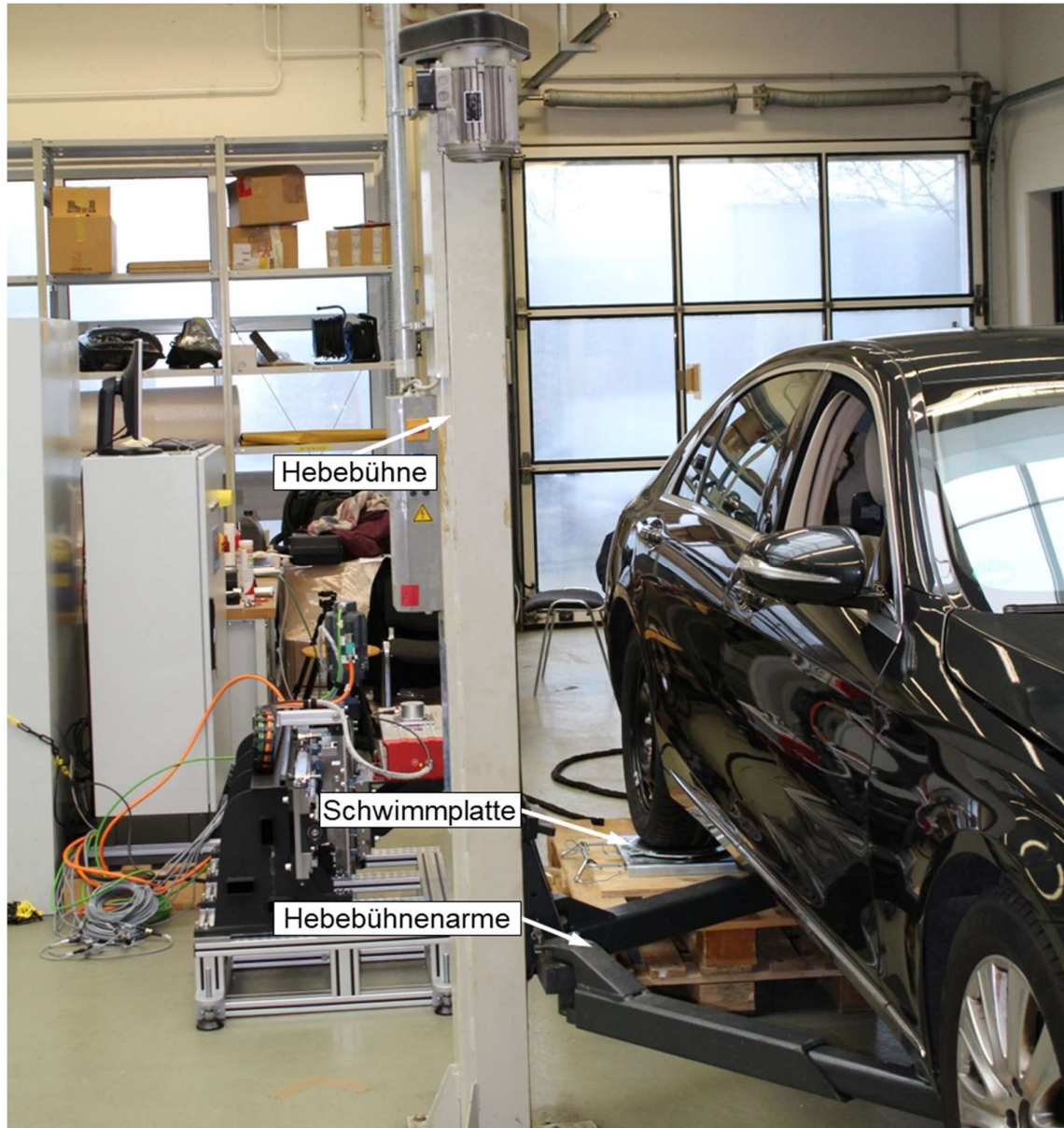
Abbildung 100 Hebebühne zur Einstellung der Ausfederung unter Federkraft
