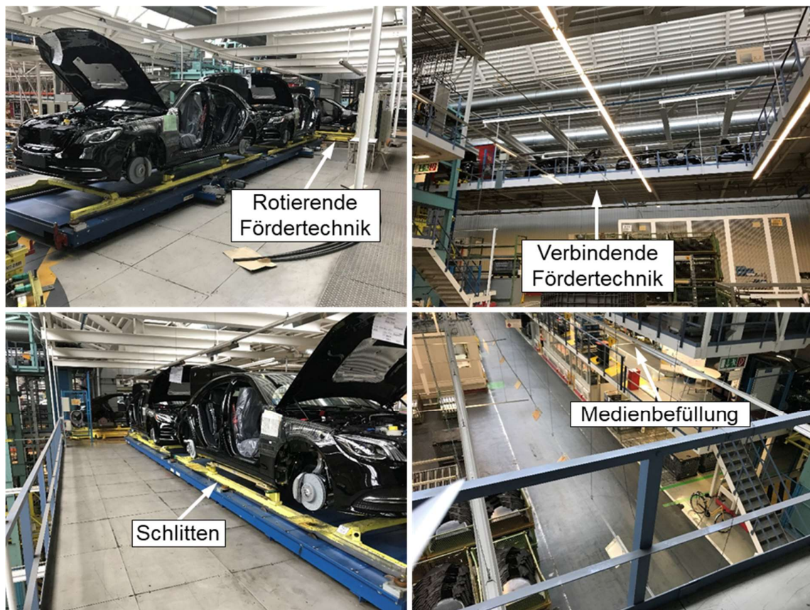
Abbildung 111 Standort und Fördertechnik für den Betriebsversuch
