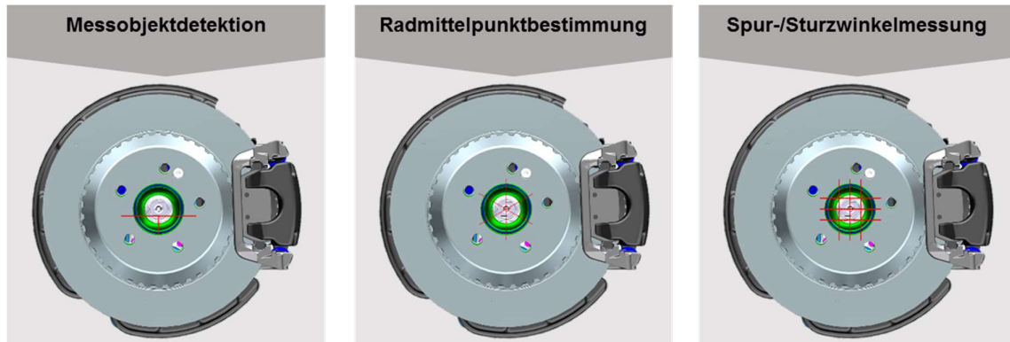
Abbildung 92 Messaufgaben bei der Inline Fahrwerkgeometrievermessung
