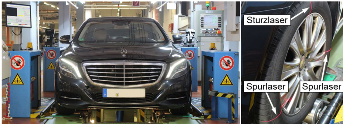
Abbildung 30 Fahrzeug auf dem Fahrwerkstand zentriert und vermessen
