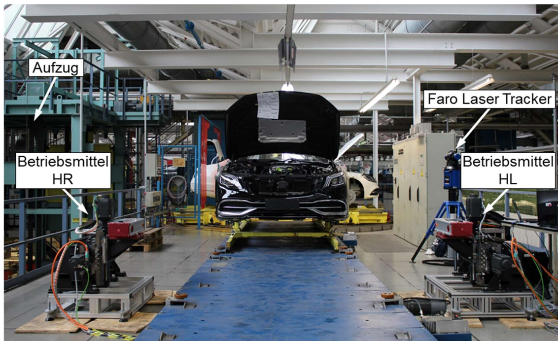
Abbildung 112 Aufbau der Betriebsmittel für den Betriebsversuch
