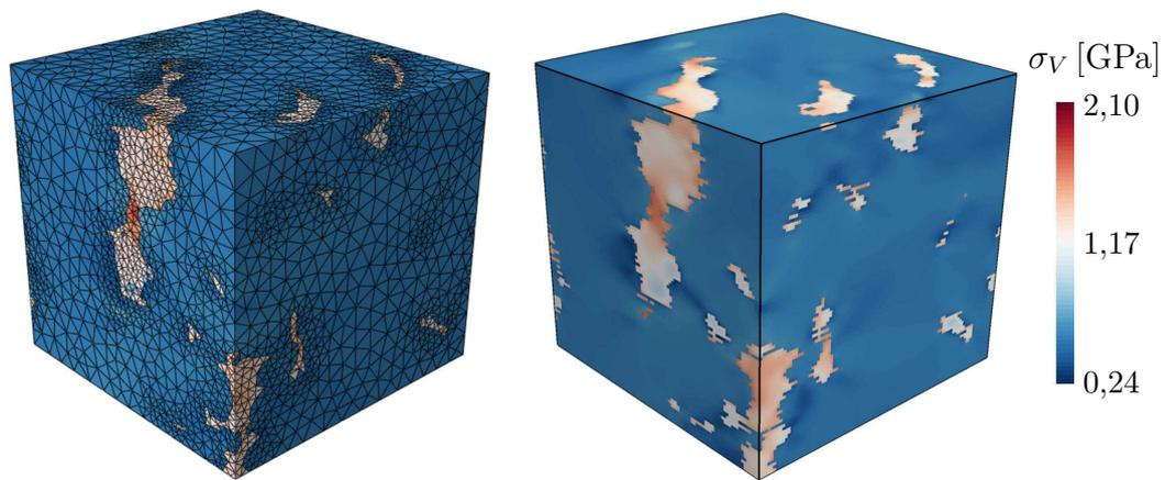
Abbildung 8.17: Darstellung der lokalen Verteilung der Vergleichsspannung nach von Mises für eine Simulation mit *ABAQUS* (links) und eine Simulation mit *LPMPP* (rechts).
