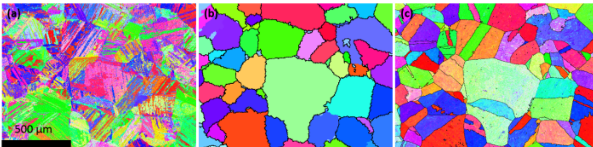
Abb. 4.4: Rekonstruktion der ehemaligen Austenitkornstruktur einer unverformten Probe aus Orientierungsbeziehungen, (a) EBSD-Map, (b) Rekonstruktion mit ARPGE 1.7, (c) Rekonstruktion mit Merengue 2.
