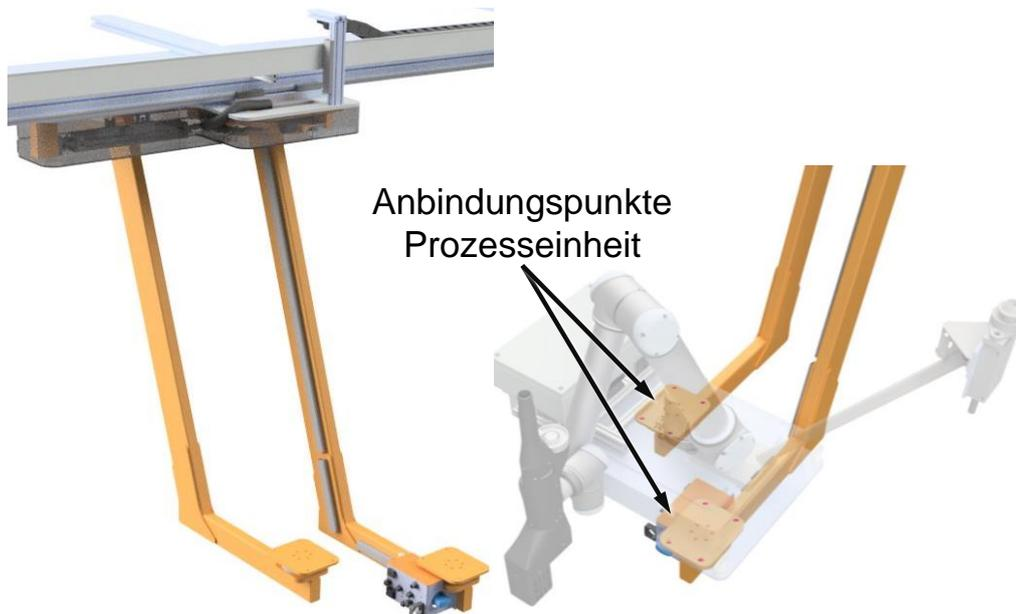
Abbildung 7.37: Transportsystem und Anbindung der Prozesseinheit
