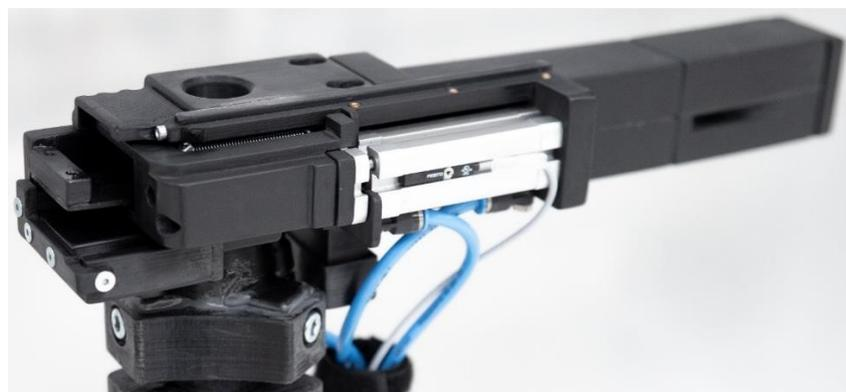
**Abbildung 7.27: Schraubenzuführeinheit mit Magazin**
