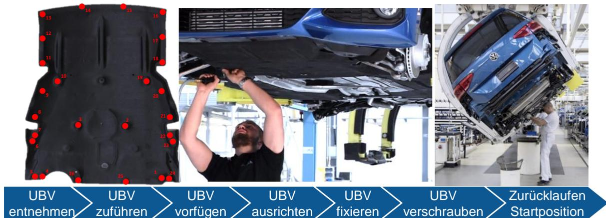
**Abbildung 7.2: Montageprozess der Unterbodenverkleidung [VOL16]**
