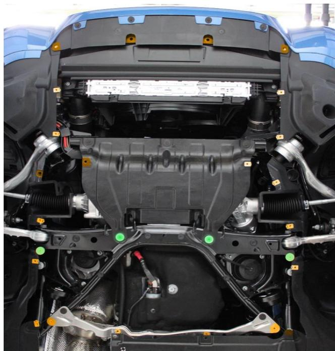
**Abbildung 7.9: Anbindungspunkte der UBV am Fahrzeugunterboden**
