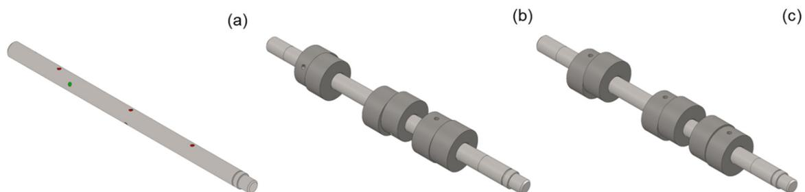
**Abbildung 6.28:** CAD-Modell Antriebswelle; (a) Welle mit Bohrlöchern (b) Kurvenscheibenpaaren mit  $120^\circ$  Verdrehung; (c) Kurvenscheiben in Reihe
