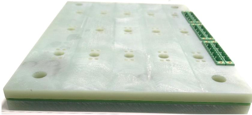
**Abbildung 6.27:** Reale Basisplatte des Ermüdungsmoduls
