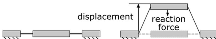
Abbildung 6.6: Schematische Darstellung der mechanischen Belastung eines DE-Membran-Aktors
