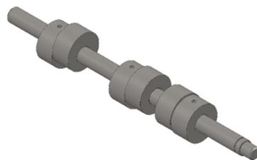
**Abbildung A.3:** Anordnung der Kurvenscheiben auf der Welle
