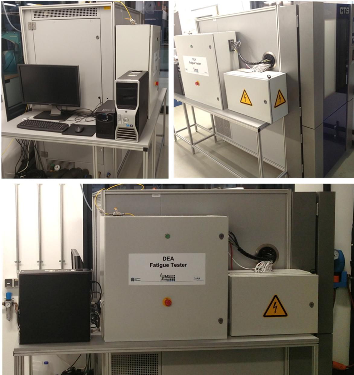
**Abbildung 6.60:** Vollständiger Ermüdungsprüfstand (Ermüdungs- und Messmodul im Klimaprüfschrank)
