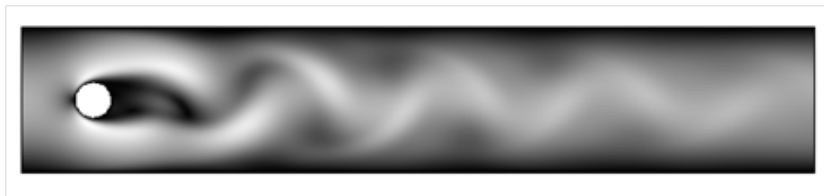
Abbildung 2.25: Simulation einer Kármánschen Wirbelstraße, durchgeführt mit der FEM-Software COMSOL Multiphysics.
