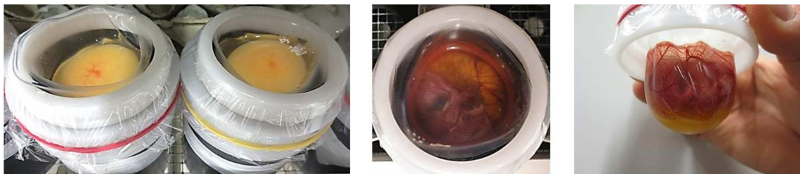
Abbildung 38: Künstliche Kulturbehälter für die Kultivierung des Hühnerembryos aus Silikon. Links: Entwicklung an Tag 3, Kulturbehälter in Halterung eingesetzt, Mitte: Entwicklung des Hühnerembryos an Tag 8, Rechts: Entwicklung an Tag 15, Kulturbehälter zur Dokumentation aus Halterung entnommen
