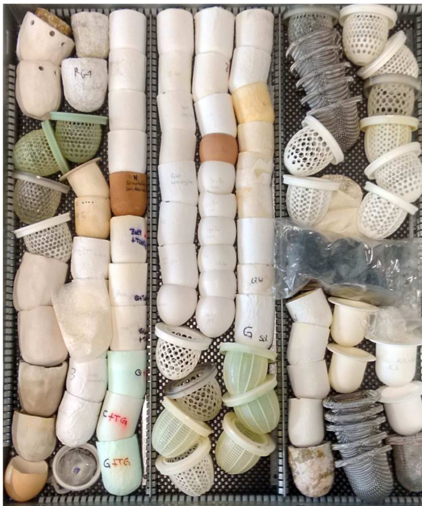
Abbildung 33: Auswahl an künstlichen Kulturbedeuten für Hühnerembryonen, die im Rahmen dieser Arbeit entwickelt, aufgebaut und im Kultivierungsexperiment untersucht wurden
