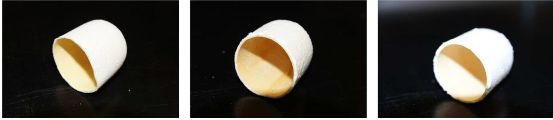
Abbildung 35: Künstliche Kulturbehälter für die Kultivierung des Hühnerembryos aus Fiberglas, Zellulose und Quarz. Links: Zellulosehülse beschichtet mit Karnaubawachs, Mitte: Fiberglasshülse beschichtet mit Karnaubawachs, Rechts: Quarzhülse beschichtet mit Silikon (MED 6015)
