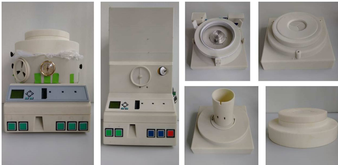
Abbildung 18: Verschiedene Versionen des Inkubators für eine In-ovo-Kultur und dazugehöriger Abdeckungen. Links: Erster Prototyp des Inkubators. Mitte: Finale Form des Gehäuses. Rechts: Vier unterschiedliche Abdeckungen
