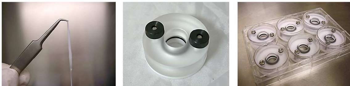
Abbildung 9: VM Kultivierungssystem. Links: VM in aufgerolltem Zustand an der Luft. Mitte: Aufspannvorrichtung aus oberem und unterem Ring. Rechts: Aufspannvorrichtungen in 6-Loch-Platte
