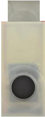
**Abbildung 27: Teflonhalter mit einer Probengröße von 4,2 cm<sup>2</sup>**
