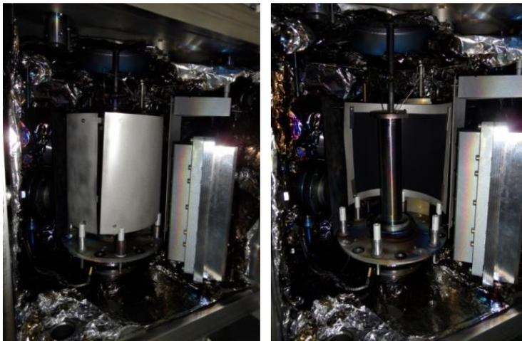
**Abbildung 26: Probenhalter und Plasmakammer zum Ätzen von DIN A4 Proben**
