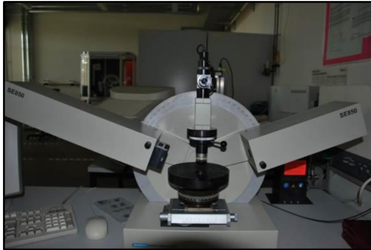
Abbildung 3-4: Darstellung des spektroskopischen Ellipsometer SE850 zur Bestimmung der Schichtdicke der Siloxanbeschichtungen.
