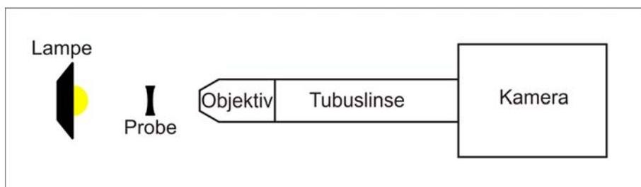
Abbildung 4.3: Skizze des Aufbaus zur „normalen“ Abbildung eines ausdünnenden Filaments im CaBER-Experiment.
