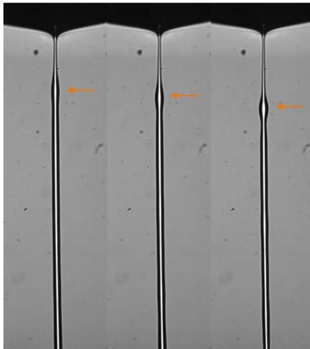
Abbildung 6.9: Bildreihe zur zeitlichen Entwicklung der einzeln anwachsenden Tropfen am oberen Rand des Filaments. Der zeitliche Abstand zwischen zwei Bildern der Serie beträgt ca. 2,86ms. Die Farbkodierung der Pfeile ist die gleiche wie in Abbildung 6.1.
