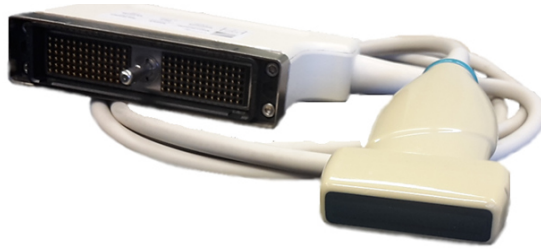
Abb. 8.5. 128-kanaliger, linearer Ultraschallwandler
