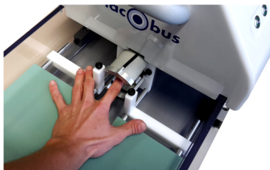
Abb. 9.8. Ablauf eines Scans der Fingergelenke über getrennte, kreisförmige Wandlersegmente in einem geschlossenen Messsystem. Die Mechanik zur Gewährleistung des Scankonzeptes ist oberhalb der Wandler integriert.
