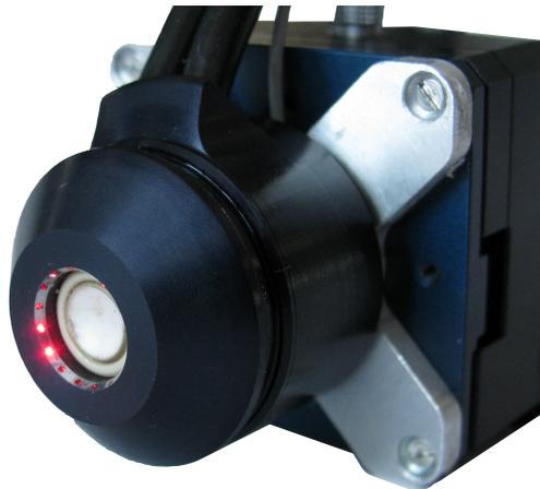
**Abb. 4.10.** Prototyp des Lichtwellenleiters für die Beleuchtung des Fokusbereichs des Ultraschallwandlers
