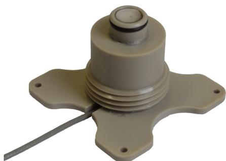
**Abb. 4.7.** Photographie des Ultraschallwandlers zur *in-vivo* Bildgebung
