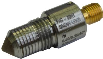
**Abb. 4.3.** Photographie der entwickelten 400  $MHz$  Linse zur konfokalen optoakustischen Mikroskopie
