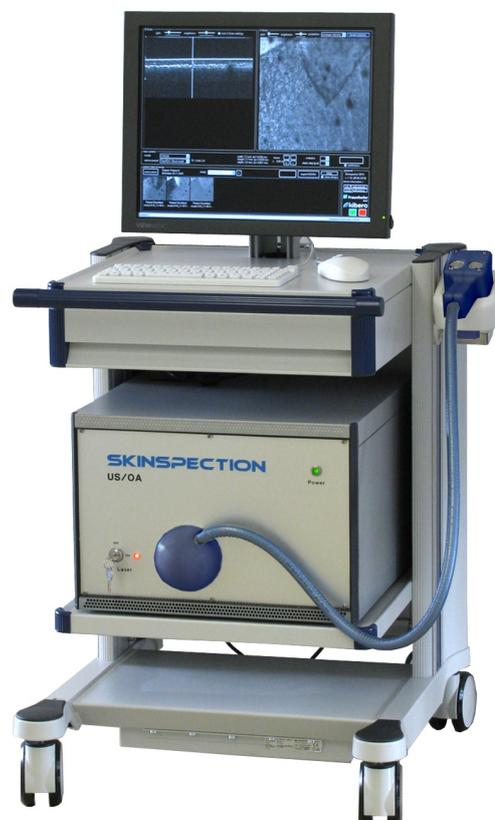
Abb. 4.13. Photographie des entwickelten Systems zur hochaufgelösten *in-vivo* optoakustischen Bildgebung
