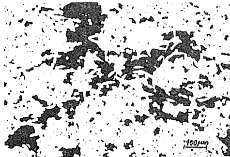
Bild 7 Schliffbild einer CVI-SiC/SiC-Probe mit unidirektional gelegten Kurzfasern
