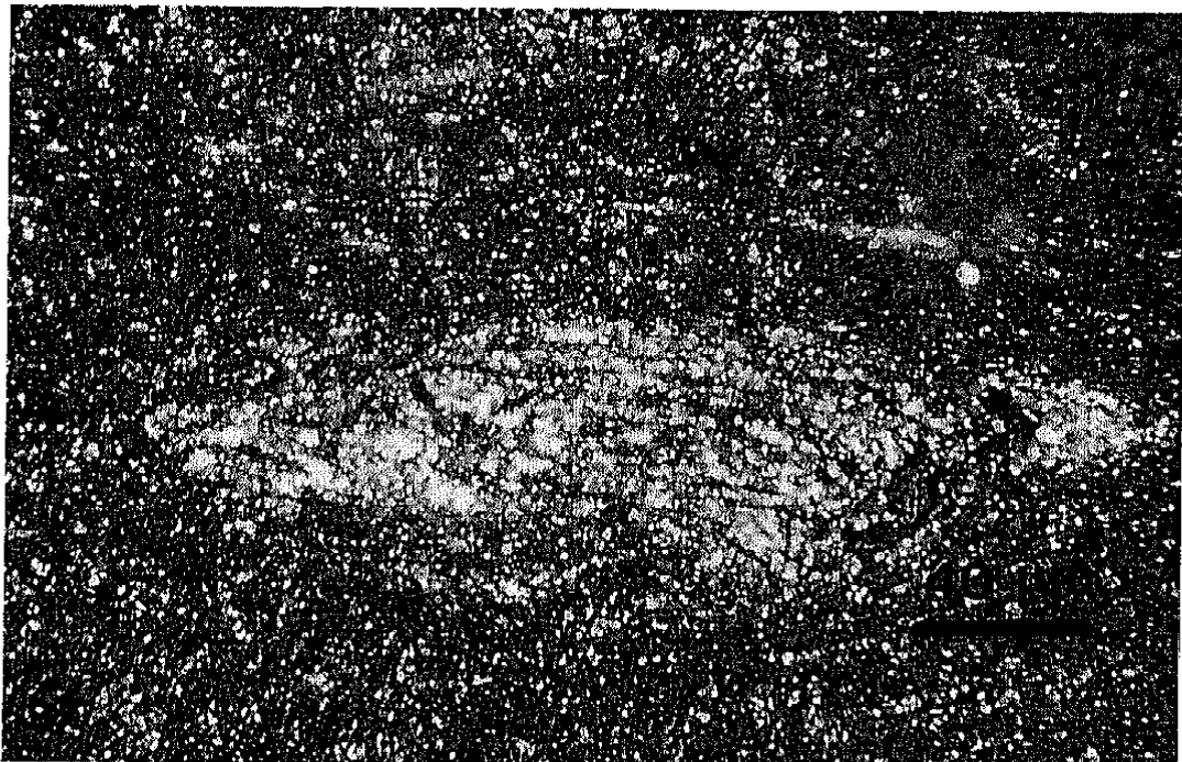
Bild 8: Dispersoidanhäufung, Lichtmikroskop Dunkelfeld
