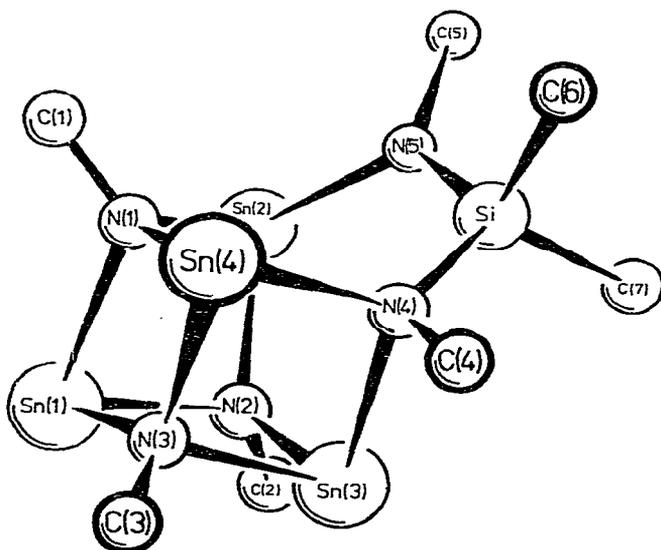
Fig. 2. Die Molekülstruktur von  $\text{Sn}_4(\text{NMe})_5\text{SiMe}_2$  (III) nach Röntgenstrukturanalyse. Jedes gezeichnete Kohlenstoffatom hat noch 3 Wasserstoffatomen.
