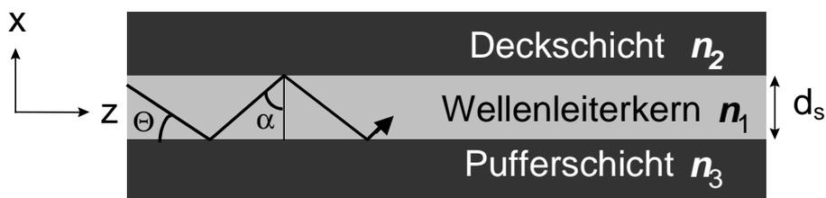
Bild 11 Schematischer Aufbau eines z-invarianten Dreischichtwellenleiters
