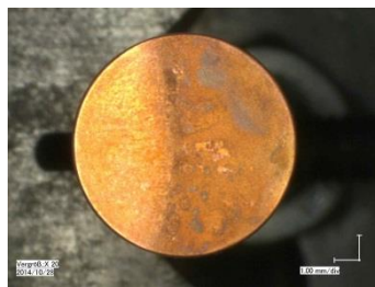
Abbildung A.2: Foto der Verschmutzung auf einem Kupfer-Werkstück
