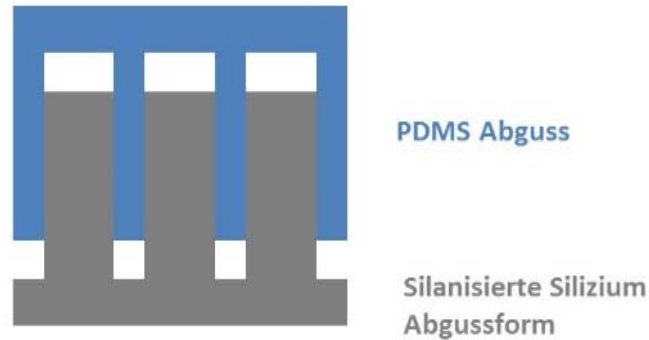
Abbildung 14: Schematische Darstellung eines PDMS Abgusses von einem Siliziumwafer, beim Abguss werden die Maße invertiert: Was im Silizium die Grabenbreite war, entspricht im PDMS der Trennwandbreite und umgekehrt.
