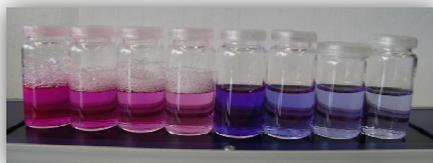
**Abbildung 5-8.** Wässrige Lösung von NILROT in **31** (links) und anionischem CD (rechts) in Abhängigkeit der CD-Konzentration (v. l. n. r. abfallend)
