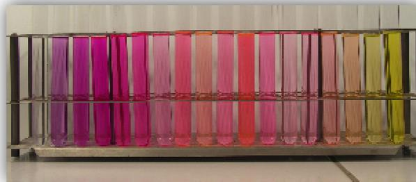
**Abbildung 5-7.** Nilrot gelöst in polaren (*links*) und apolaren (*rechts*) Lösemitteln:  $\text{H}_2\text{O}$ , AcOH, MeOH, EtOH,  $^i\text{PrOH}$ , DMF, Acetonitril, EE, *tert*-Butyl-methylether, THF, 1,4-Dioxan, Aceton, Chloroform, DCM, Toluol, Tetrachlormethan, Cyclohexan und Hexan (v.l. n.r.).
