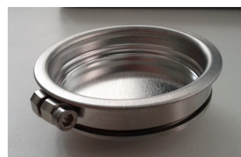
Abb. 31: Pfanne zur Verminderung des Austretens der Probe aus dem Platte/Platte-Spalt während der rheologischen Messung.
