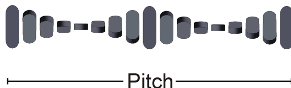
Schema 1: Schematische Darstellung der helikalen Struktur eines cholesterischen Flüssigkristalls.
