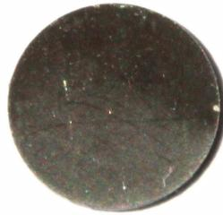
**Abbildung 3.3:** Pellet aus gepressten nanokristallinen PdAu-Partikeln.
