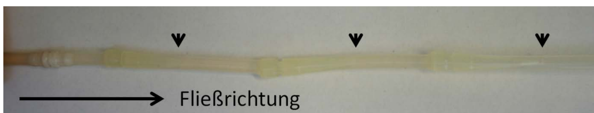
Abbildung 5.5: Homogenisator. Die im Schlauch untergebrachten Pipettenspitzen simulieren das Auf- und Abpipettieren einer Schüttelflaschenkultur zur Homogenisierung. Die Pfeile deuten die Enden der Pipettenspitzen an. Die Durchmesser der Spitzenöffnungen wurden durch Abschneiden der Spitzen vergrößert. Durch eine Anordnung der Spitzen mit abnehmendem Spitzendurchmesser in Flussrichtung, wurde eine Vorzerkleinerung der Klumpen erzielt, die eine Verstopfung verhinderte.
