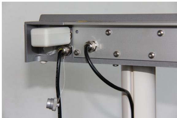
Abb. 5.6: Kontaktierung des Sensorknotens an einer Personenwaage der Firma Soehnle zur Erfassung und drahtlosen Übertragung des Körpergewichts.
