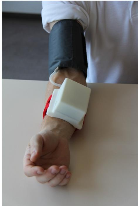
Abb. 5.4: Gesamtsystem zur Erfassung und drahtlosen Übertragung des systolischen und diastolischen Blutdruckwertes.
