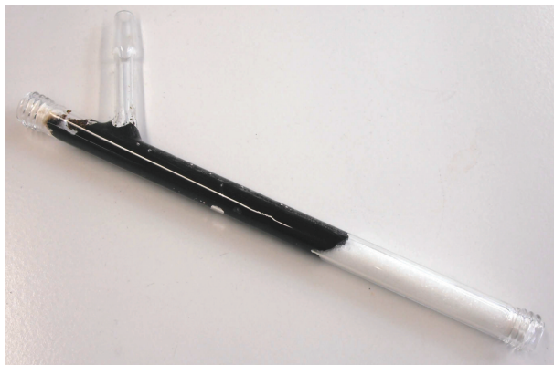
Abbildung 15: Verbrauchter Zuckerabsorber des Einfach-Strömungsrohrreaktors
