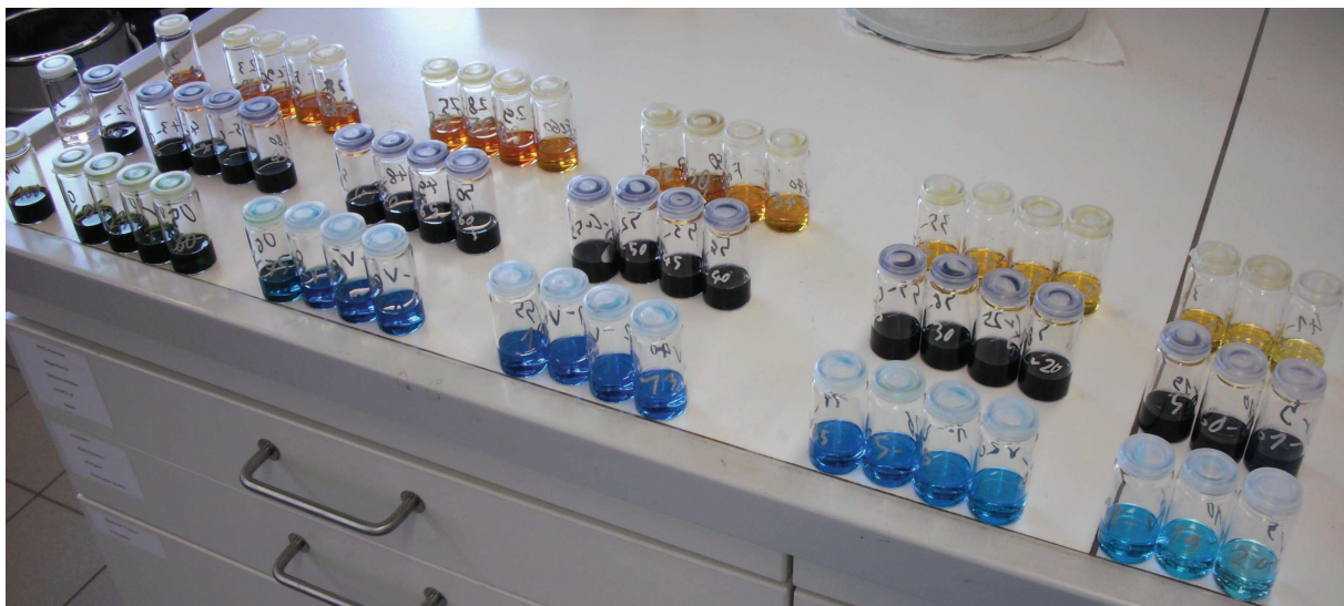
Abbildung 23: Über die Ethylenglykolroute hergestellte Gele der Systeme V / Sn, Cr / Sn und Fe / Sn
