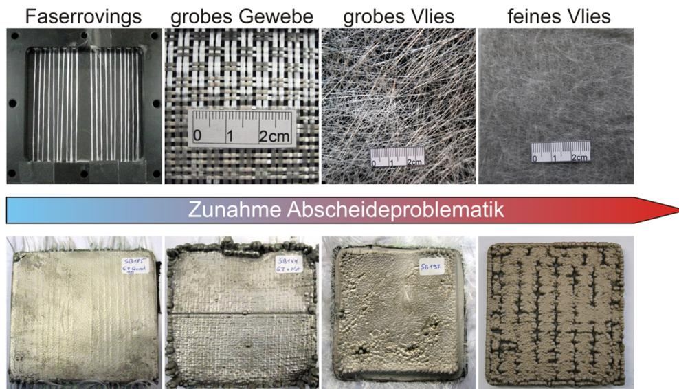
Abbildung 7.50: Abscheideproblematik in Abhängigkeit der Verarbeitungsform der Fasern.
