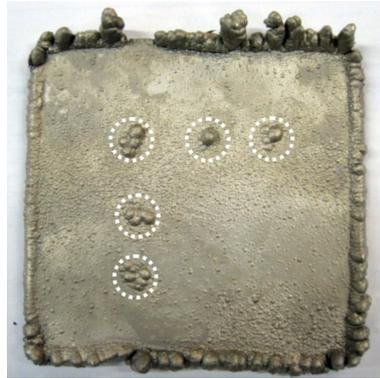
Abbildung 7.56: Einfluss von Permanentmagneten auf die Abscheidung von Nickel.
