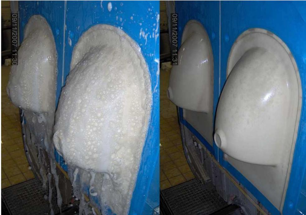
Abbildung 3.3: Ausspülung einer Druckgussform mit Wasser (links) und mit Luft (rechts) am Ende eines Gusszyklus.
