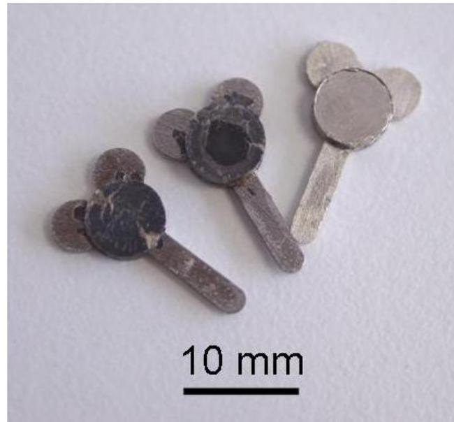
Abbildung 4.31: Gussteile aus AMZ4 hergestellt bei unterschiedlichen Prozessatmosphären: Ar-Inertgas (links), Evakuierung auf  $\approx 10^{-1}$  mbar und Wiederbefüllen mit Ar-Inertgas (Mitte), Evakuierung auf  $\approx 10^{-3}$  mbar und Wiederbefüllen mit Ar-Inertgas (rechts)
