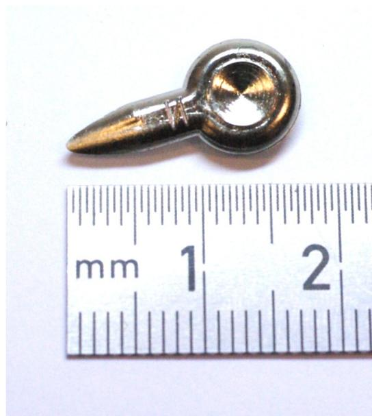
Abbildung 4.32: Instrumentenzeiger aus AMZ4 als Demonstrator amorpher metallischer Gussteile hergestellt in Endform im Druckgussverfahren [113]
