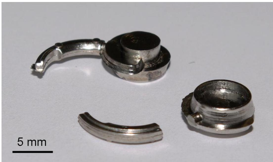
Abbildung 4.35: Prototypen amorpher metallischer Gussteile aus AMZ4 mit (oben) und ohne Anguss (unten) für die Anwendung in einer mikromechanischen Baugruppe
