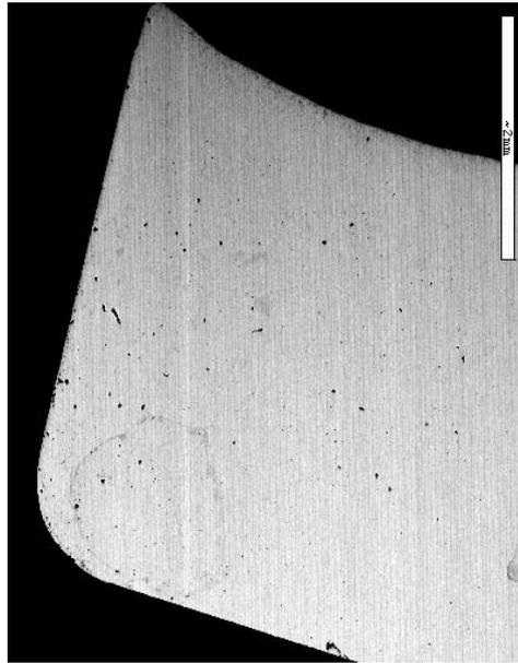
Abbildung 3.9: REM-Aufnahme eines Querschnitts eines Schmelzguts aus einer Zr-Legierung nach Legieren und Erstarren in einem Glaskohlenstofftiegel. Das erstarrte Material konnte als Negativ der Tiegelgeometrie durch Stürzen entformt werden, eine Infiltration der Tiegeloberflächen fand nicht statt.
