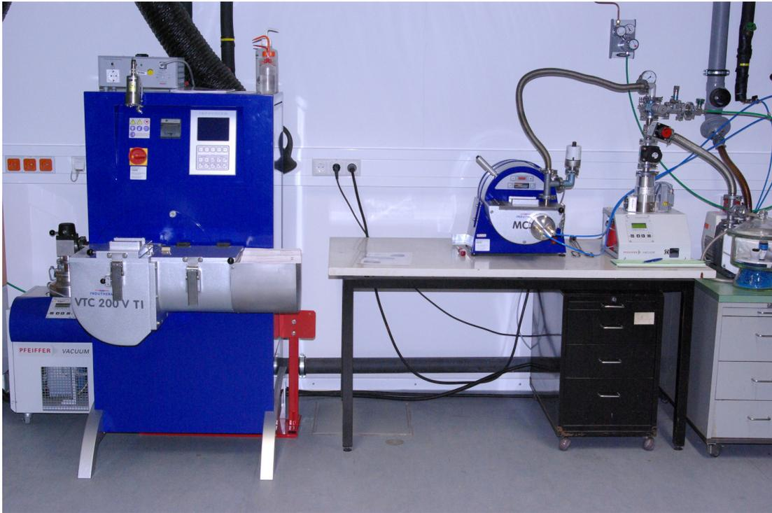
Abbildung 5.6: Induktive Vakuumpkippgussanlagen mit einem Tiegelvolumen von 10 ml (rechts) bis 370 ml (links)
