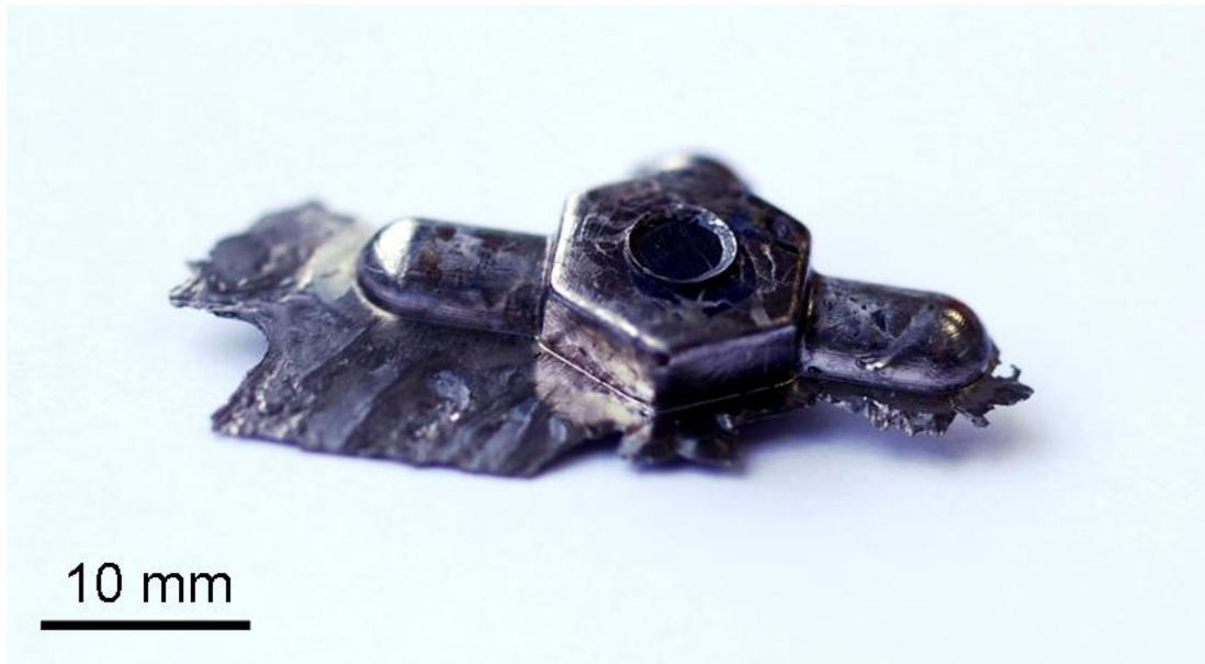
Abbildung 4.30: Gussteil aus Versuchen zum Formfüllverhalten: Sowohl Form als auch angrenzende Spalte in der Werkzeugtrennebene sind gefüllt.
