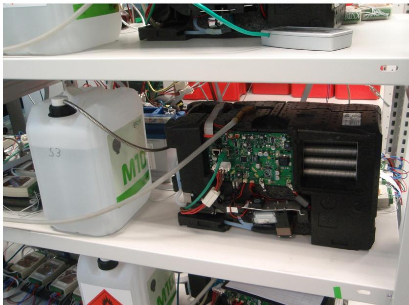
Abbildung 4.9: Eines der efoy 900-Systeme mit geöffnetem Gehäuse.
