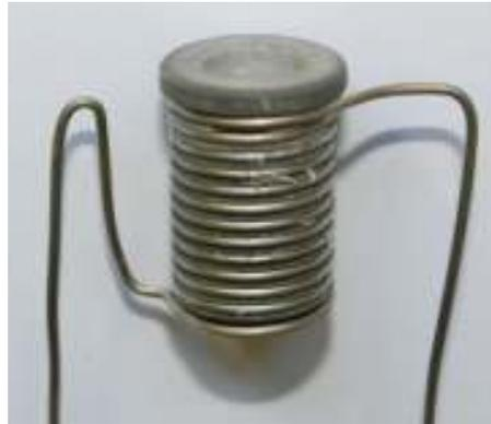
**Abbildung 6: Stenantiegel mit Molybdän-Drahtwicklung.**
