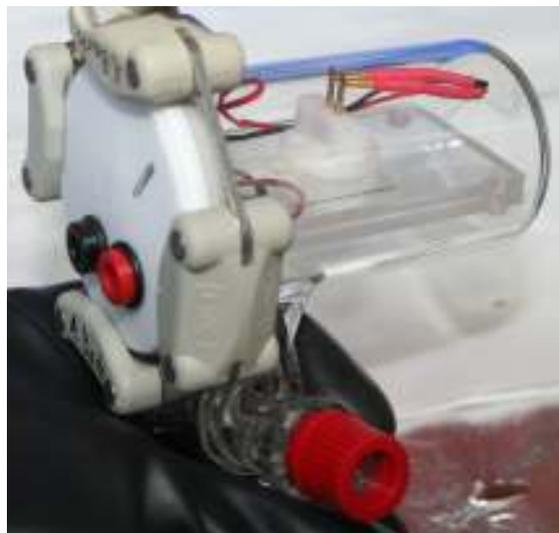
Abbildung 23: Glasgefäß mit Kontaktierung zur Durchführung der Leitfähigkeitsmessungen.
