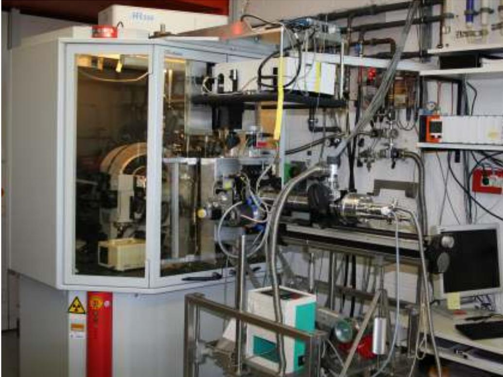
Abbildung 14: Röntgendiffraktometer mit Transfersystem während der Charakterisierung.
