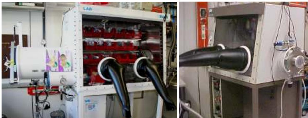
Abbildung 12: Handschuhboxen, links: MBRAUN Labstar (1200/780), rechts: MB 120B.
