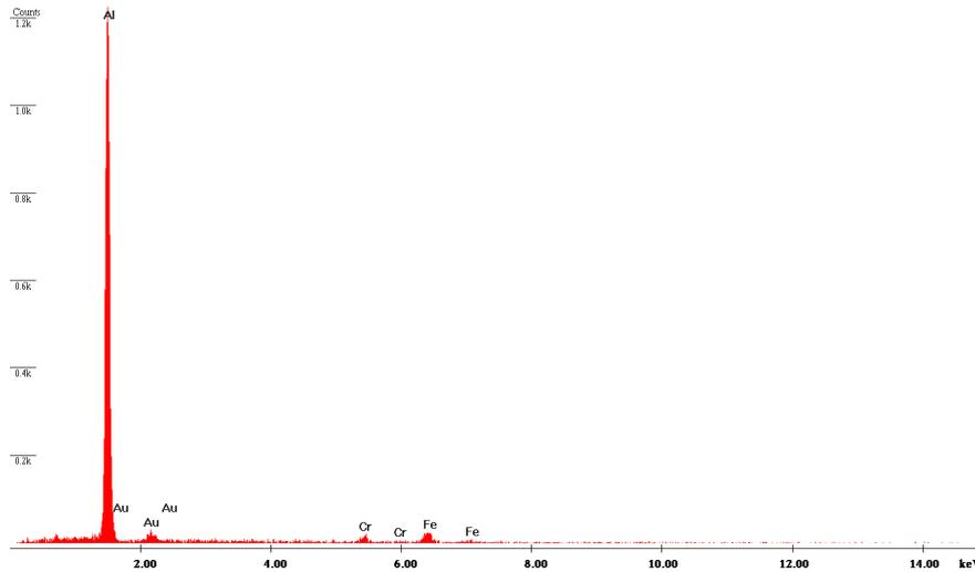
Abbildung 76: EDX– Spektrum nach der Abscheidung (auf Stahl, bei 350 °C)
