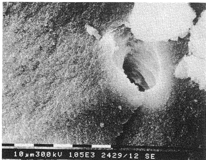
Abb.4-3 Faserloch im Grünkörper, hervorgerufen durch Binderrückstände.
