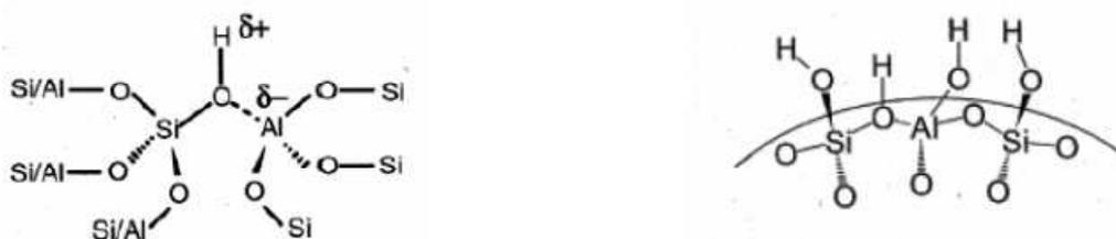
Abb. 2-10. Verbrückte (links) und endständige (rechts) Hydroxylgruppen [83]
