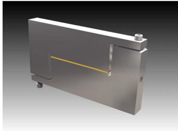
**Abb. 29:** Zur Montage der Scherproben werden die entsprechenden Spacer zwischen den Spacerflächen eingelegt und die Probenhälften mit 2 x M6 verschraubt. **Abb. 30:** Scherprobe mit gefülltem Klebspalt (gelb).
