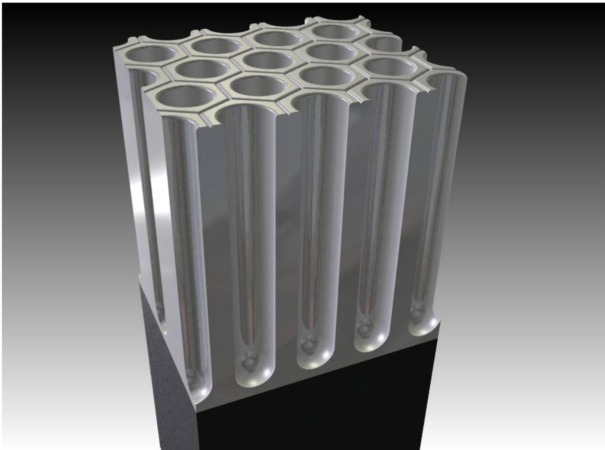
**Abb. 34:** Ausschnitt aus einer Eloxal-Schicht mit idealer, wabenförmiger Struktur.
