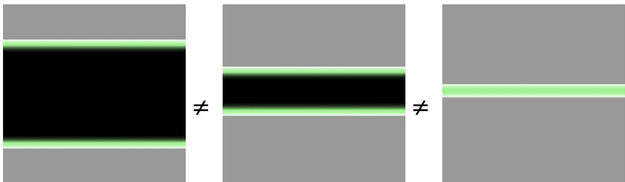
**Abb. 1:** Zunahme des relativen Volumenanteils einer Interphase im Falle einer Klebung bei sinkender Klebschichtdicke (Fügepartner = grau, Bulk = schwarz, Interphase: grün).
