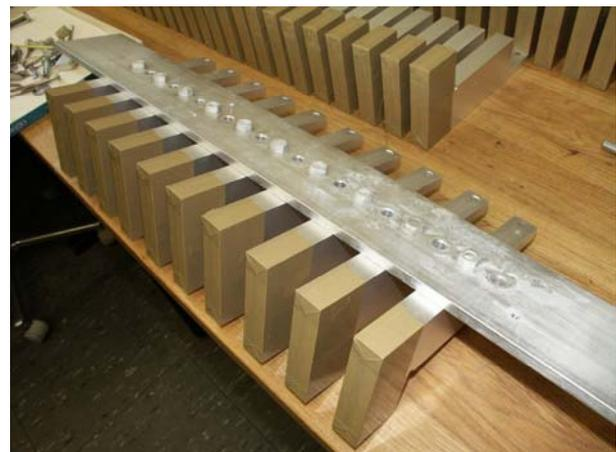
**Abb. 35:** Hälfte einer Scherprobe. Flächen welche nicht anodisiert werden müssen, aber während der Anodisation ebenfalls im Elektrolyt hängen werden mit Klebeband abgeklebt und somit isoliert.
