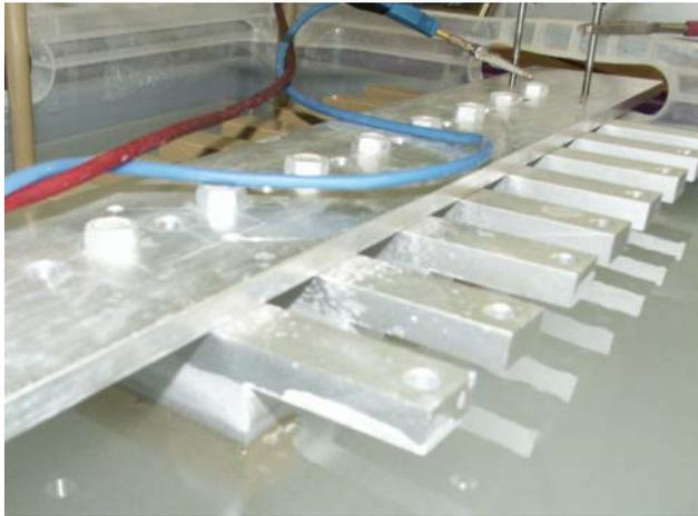
**Abb. 39:** Probenkörper während der Anodisation. Das Bad wird durch den an der Kathode entstehenden gasförmigen Wasserstoff milchig trüb. Die Anodisation ist deshalb und wegen der ebenso aufsteigenden Säuredämpfe nur unter dem Abzug vorzunehmen.
