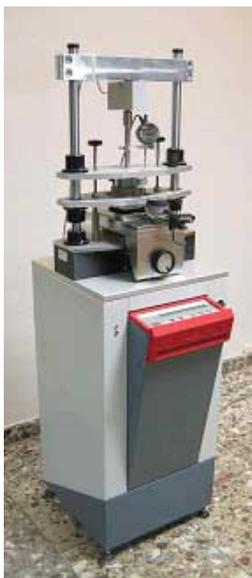
**Abb. 61:** GIESA RS5 simple shear [124].
