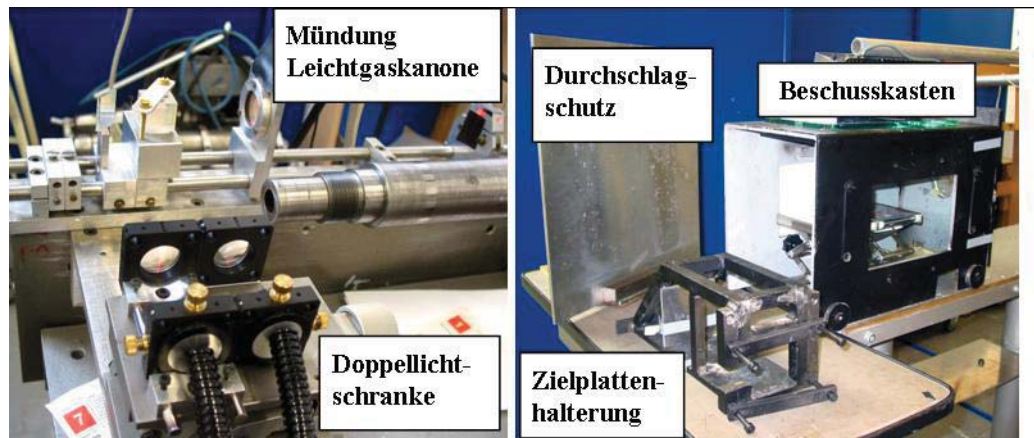
Abbildung 6.40: Doppellichtschanke und Beschusskasten.
