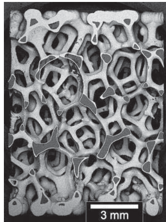
Abbildung 2.6: Beschichteter Metallschaum nach [21]. Man erkennt deutlich eine inhomogene Schichtdickenverteilung.
