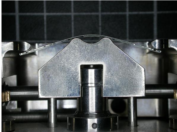
FIGURE 8.1: Photo de l'essai de flexion 4 points.
