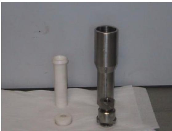
**Abbildung 2-14: Fotografie des 50ml Stahlautoklaven. Abgebildet sind das Tefloninlet mit zugehörigem Deckel, Berstscheibe und der Stahlkörper des Autoklaven.**
