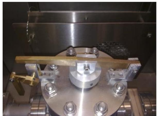
**Abbildung 2-42: Fotografien der Abzugs-Mechanik; (links) Magnet hält FB; (rechts) Magnet wird vom Deckel abgehoben und FB fällt im Inneren der Probenkammer.**
