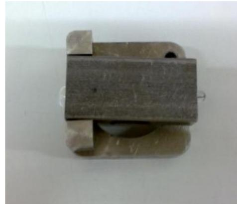
**Abbildung 2-41: Fotografien vom erweiterten Probenhalter; (links) geöffneter Schlagblock mit Zertrümmerkante; (rechts) geschlossener Einbauzustand; auf beiden Fotografien ist außerdem deutlich die Gewindebohrung zu sehen, die zur Einbringung des Probenhalters in C3 benötigt wird.**
