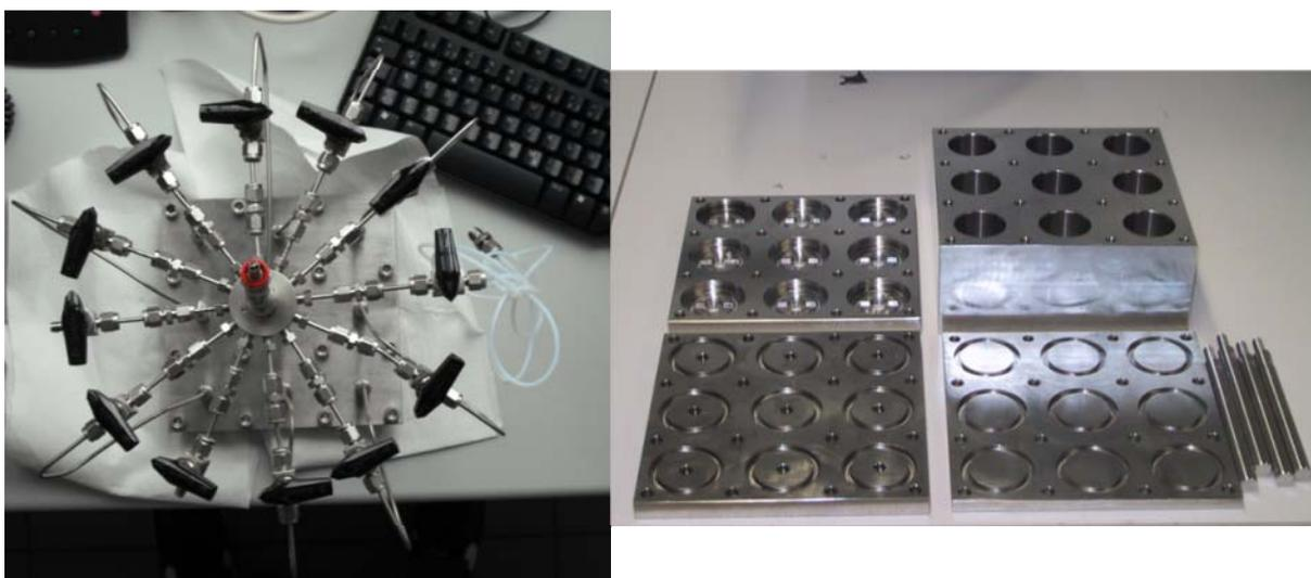
**Abbildung 2-22: Fotografien von Bauteilen des 9-fach Reaktors; (links) Manifold und Rohrverbindungen über Kugelhähne zum Reaktordeckel; rot herausstehend die Schnellkupplung an einem Eingang des Manifolds (rechts) beginnend beim Reaktorblock im Uhrzeigersinn: der Reaktorblock, Bodenverschlussdeckel für Drucksynthesen und Standbeine des Reaktors, Reaktordeckel und schließlich Bodenverschlussdeckel für die Membranfiltration.**
