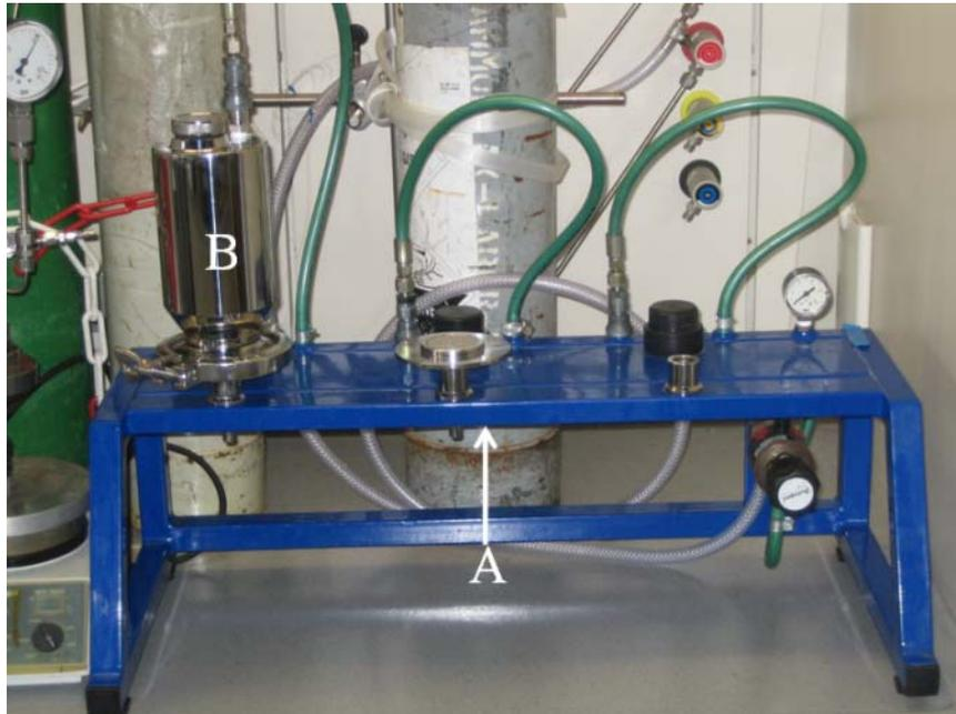
**Abbildung 2-15: Fotografie des verwendeten 3-fach-Ultrafiltrationsstands (A); links auf dem Filtrationsstand ist eine betriebsbereite Filtrationseinheit abgebildet (B).**
