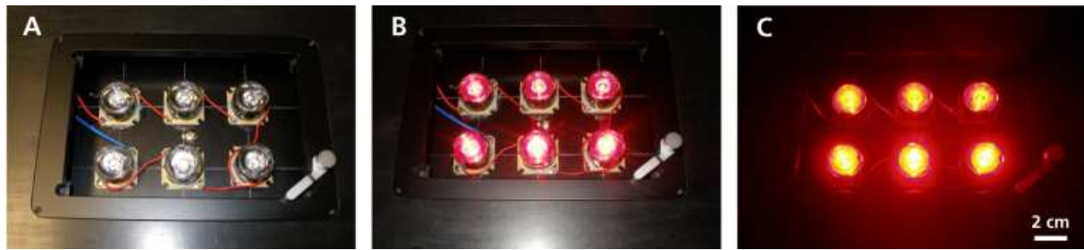
Abb. 10: Aufbau der Bestrahlungseinheit zur Bestrahlung von Proben.
