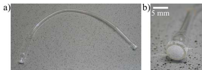
Abb. 2.21 Verwendete Salzbrücke a) Gesamtansicht b) glaseingefasste Fritte mit einer Porosität von 1.
