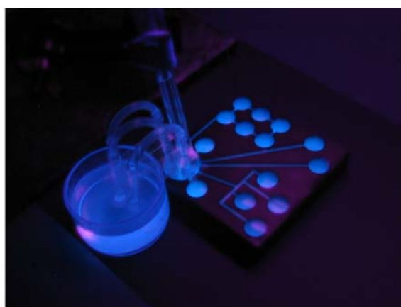
Abb. 2.29 Übersicht über den Messaufbau bestehend aus mit Elektrolyt befüllter, strukturierter Graphitplatte und Referenz- und Gegenelektrodenbereich unter UV-Anregung.
