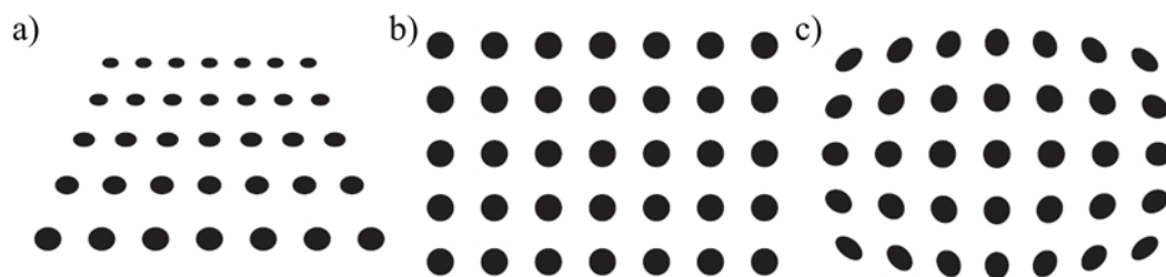
Abb. 2.36 Effekt eines perspektivischen Fehlers (a) und einer nichtlinearen Verzerrung (c) bei einer falschen Kammeraposition auf ein Gitternetz aus Punkten, b) Bild des Gitternetzes aus Punkten bei idealer Kammeraposition, nach [250].
