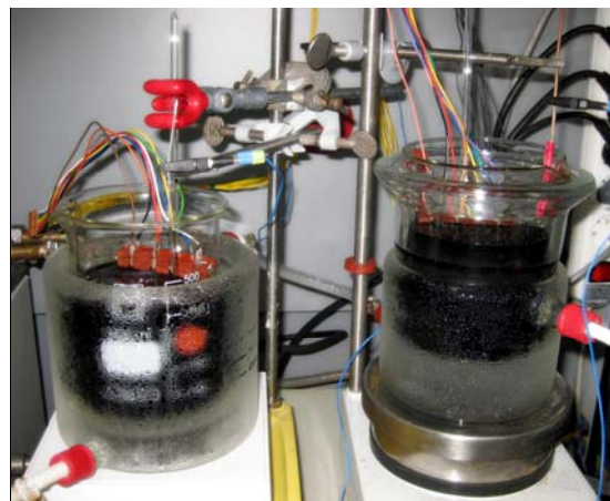
Abbildung 31: Aufbau für eine elektrochemische Multi-Abscheidung
