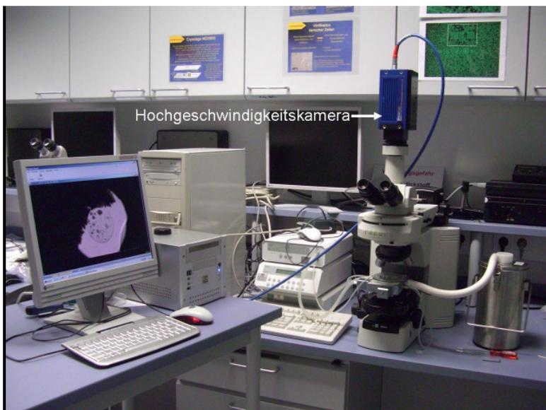
**Abbildung 3.5:** Anlage zur Hochgeschwindigkeitskryomikroskopie. Auf das Kryomikroskop, wie in Abbildung 3.4 beschrieben wird eine Hochgeschwindigkeitsvideokamera aufgesetzt. Besonders zu beachten ist dabei die ausreichende Beleuchtung der Probe.
