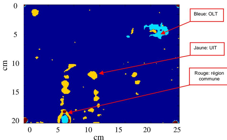
Figure 7.46: Superposition d'images segmentées obtenues par thermographie lockin et excitation par ultrasons. Les parties colorées représentent les défauts: la couleur bleue représente les défauts détectés par thermographie lockin, jaune par thermographie excitée par ultrasons et rouge la partie défectueuse commune aux deux méthodes.
