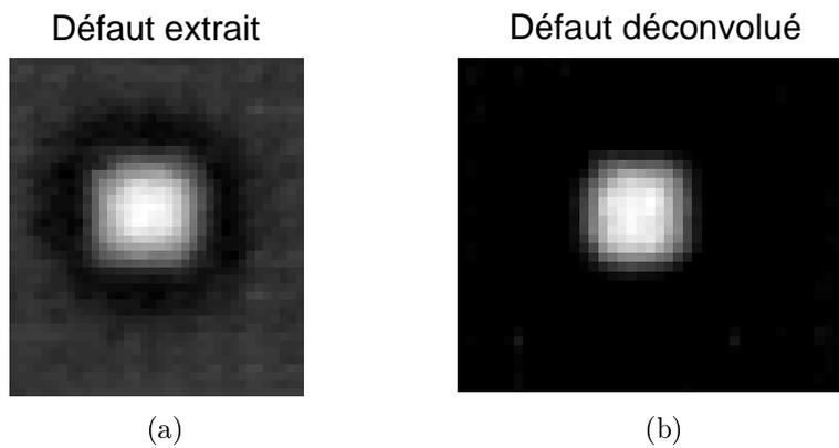
Figure 7.36: Défaut carré extrait et déconvolué de profondeur 2 mm à une fréquence de 0.03 Hz.
