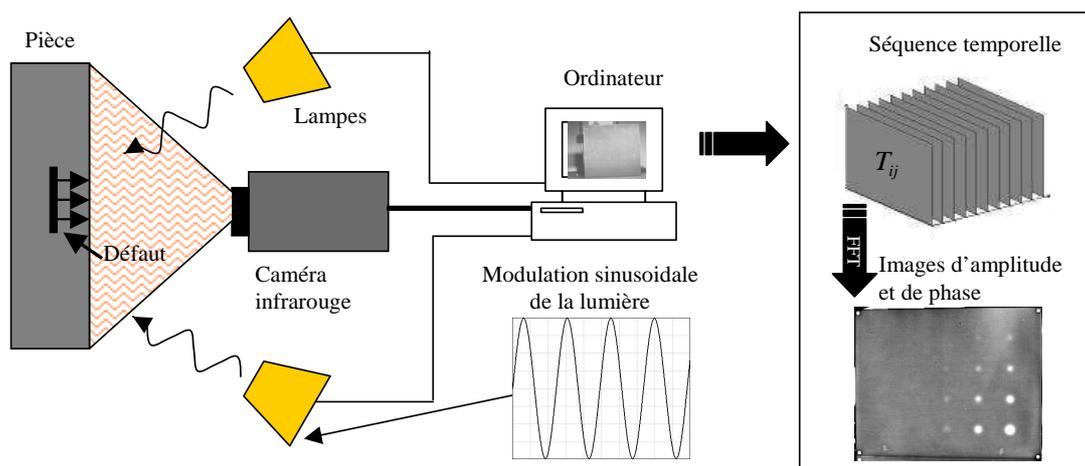
Figure 7.23: Principe de la thermographie optique lockin.
