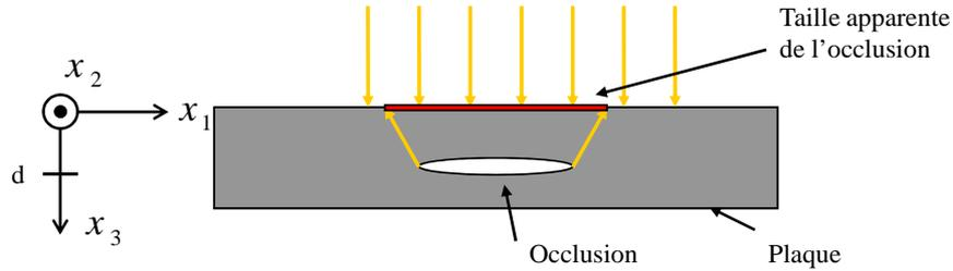
Figure 7.25: Schéma de la plaque supposée être suffisamment épaisse (modèle semi-infini) avec une occlusion plate située à une profondeur  $d$ . Dû à la diffusion thermique, un défaut apparaîtra plus grand et flou à la surface du matériau.
