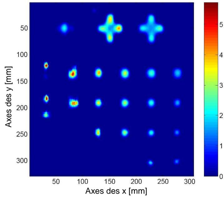
Figure 7.35: Carte de profondeur de la plaque II obtenue après déconvolution. La barre colorée sur la droite indique la profondeur des défauts en mm.
