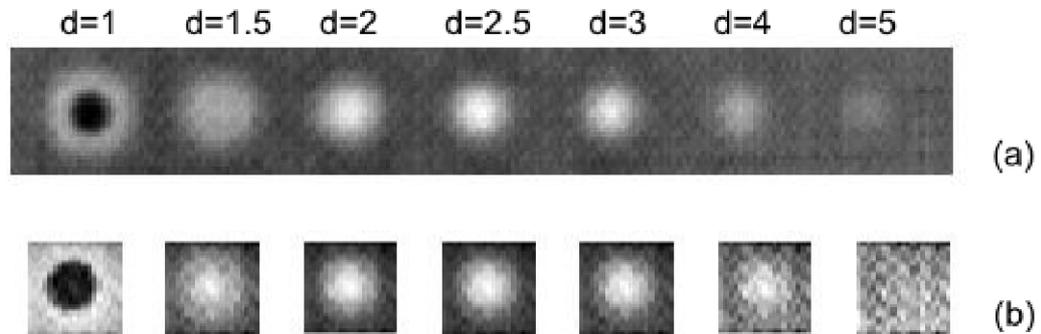
Figure 7.27: (a) Mesures thermographiques de phase d'un défaut à plusieurs profondeurs et (b) simulations correspondantes des défauts en prenant  $\alpha = 0.28 \text{ mm}^2 \cdot \text{s}^{-1}$  pour une fréquence lockin de 0.01 Hz.
