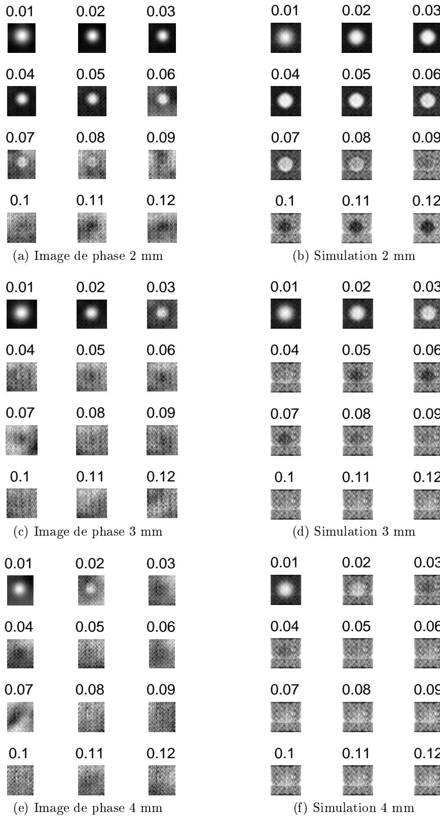
Figure 7.28: (a-c-e) Mesures thermographiques de phase et (b-d-f) simulations d'un défaut à plusieurs profondeurs et à plusieurs fréquences lockin en prenant  $\alpha = [0.5 \ 0.5 \ 0.27] \text{ mm}^2 \cdot \text{s}^{-1}$ .
