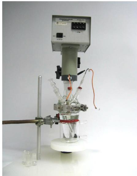
Abb. 47: Messzelle und Rotator für RDE-Experimente [PRI]
