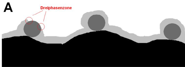
In Maximum A ist das Platinsalz vollständig reduziert. Es sind sowohl Partikel entstanden, die vollständig mit Nafion umhüllt und somit katalytisch inaktiv sind, als auch Partikel, die unvollständig mit Nafion bedeckt sind und in Kontakt zur Dreiphasenzone stehen. (Deren statistische Verteilung hängt von der Nafionmenge ab.)
