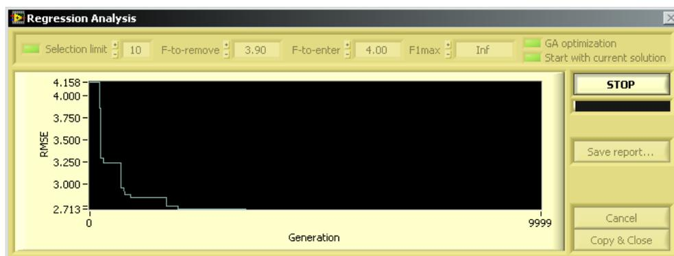
**Abbildung 48:** Benutzerdialog der Regressionsanalyse-Software während der Polynomoptimierung durch den genetischen Algorithmus (der Graph zeigt den Verlauf des Standardfehlers (RMSE) als Funktion der fortlaufend gezählten Generationsnummer)
