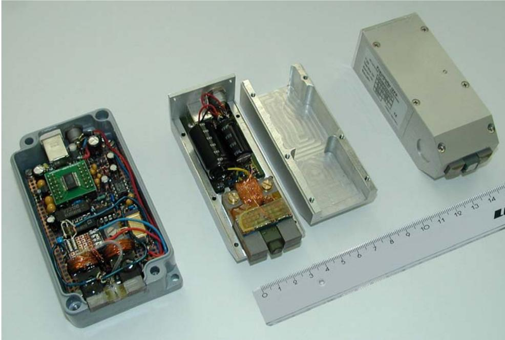
**Abbildung 52:** Entwicklung vom ersten Prototyp (links) über einen zweiten Prototypen (Mitte, mit nebenliegendem Gehäusedeckel) bis hin zum fertigen Prüfgerät (rechts)
