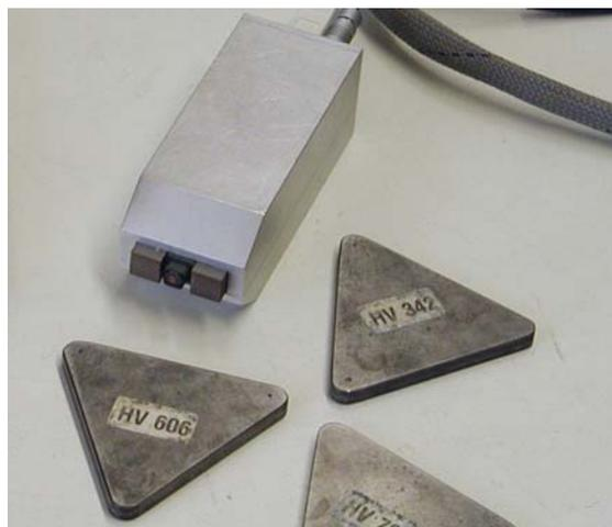
**Abbildung 75:** Härtevergleichsplatten, Prüfgerät
