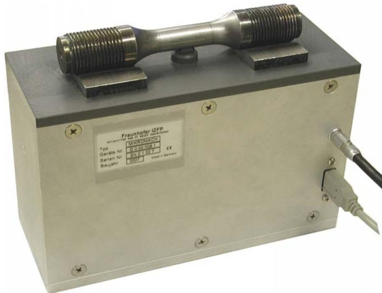
**Abbildung 106:** Prüfgerät zur Charakterisierung der thermomechanischen Alterung des Werkstoffs WB 36 (Probenlänge ca. 15 cm, Netzteil- und USB-Anschluss rechts erkennbar)
