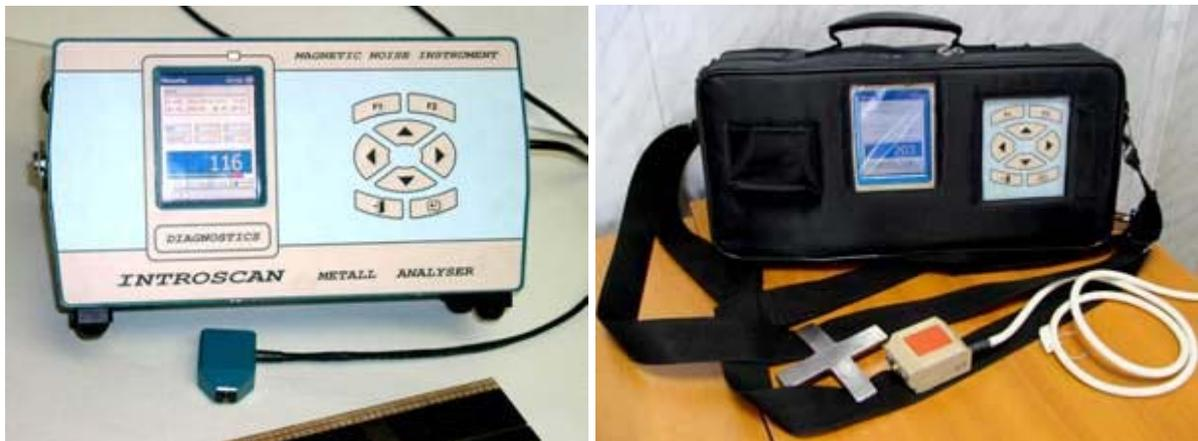
**Abbildung 26:** IntroScan-Prüfgerät; rechts eingebaut in eine Tragetasche mit integriertem Akku für den mobilen Einsatz
