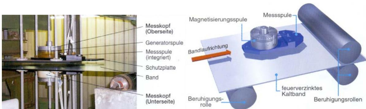
**Abbildung 29:** Prüfung an einem feuerverzinkten Kaltband mit dem IMPOC®-Prüfsystem [Dürr2003]
