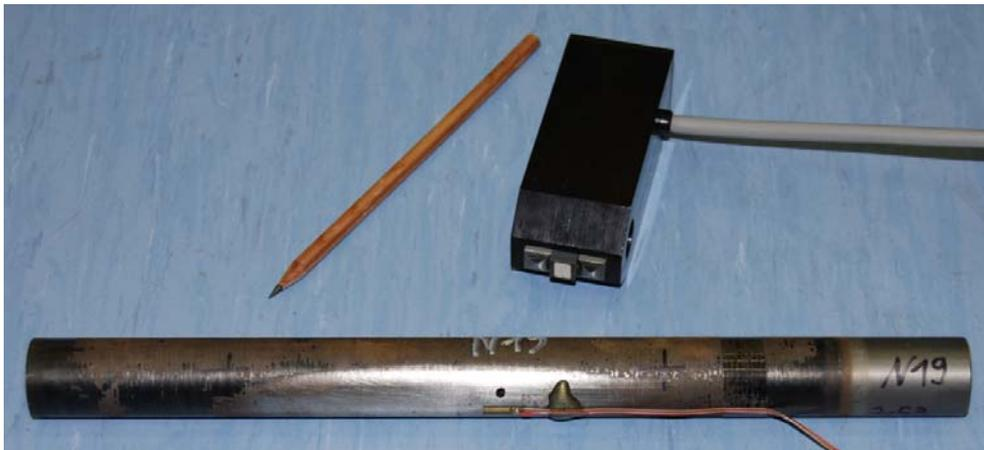
**Abbildung 87:** Neues Prüfsystem und eine der randschichtgehärteten zylinderförmigen Proben (der vorne erkennbare Dehnungsmessstreifen wurde in anderen Versuchen benötigt)
