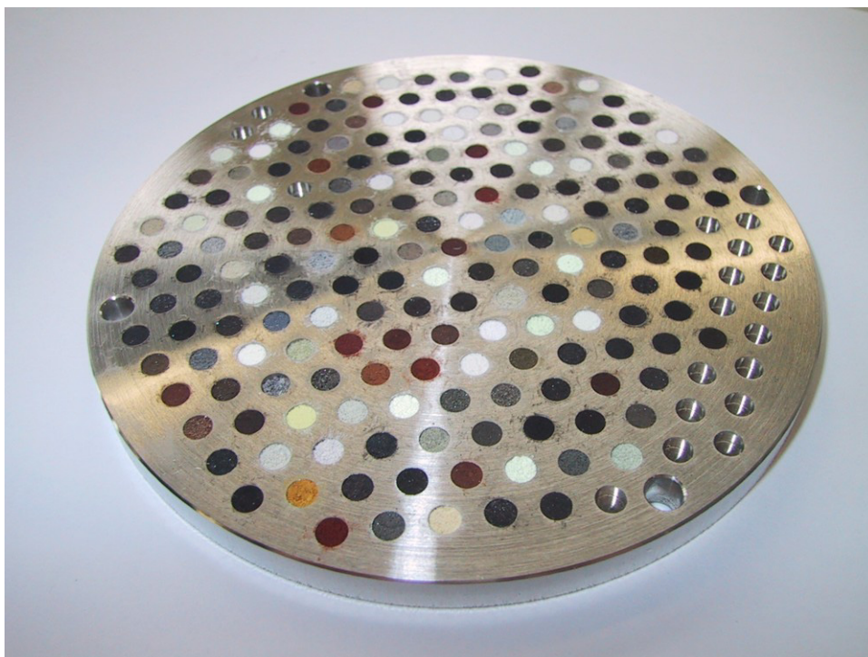
Abb. II.1: Foto einer Katalysatorbibliothek aus Edelstahl Die Platte (Bibliothek 7) wurde in zufälliger Reihenfolge mit Katalysatorpulvern gefüllt, wobei einige der 207 Vertiefungen leer blieben.
