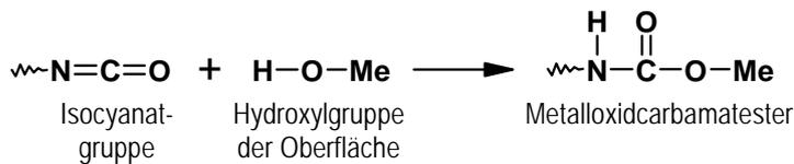
**Abb. 6.1-8:** Adhäsionsmodell für die Haftung von Polyurethanen auf Metallen durch Reaktion von Isocyanatgruppen mit Hydroxylgruppen der Oberfläche zu Metalloxidcarbamateestern (nach [335, 336]).
