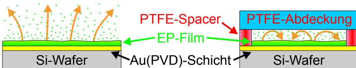
**Abb. 10.8-2:** Versuchsaufbau zur Überprüfung des möglichen Abdampfens von DETA-Monomer während der Vernetzung von Epoxidschichten ( $d_{EP} = 149 \mu m$ ) auf Gold: Spincoating nach 1 h Anpolymerisation gemäß Dünnschichtpräparation aus Abschnitt 5.4.1; eine Probe vernetzt offen (linke Seite), eine weitere Probe wird abgedeckt, um das Abdampfen des Härters zu behindern (rechte Seite).
