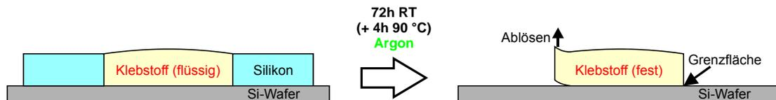
**Abb. 6.3-4:** Versuchsaufbau (schematisch) zum Abguss von Polyurethanbulkproben für die ex situ Charakterisierung mit verschiedenen Messmethoden (z. B. FTIR-ATR).
