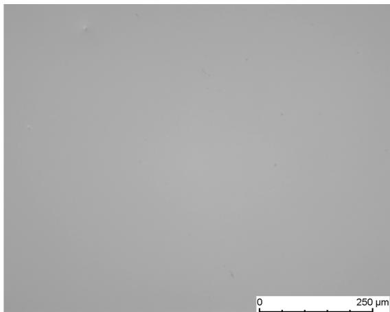
c) ca. 2 μm Polyurethanfilm auf Gold
