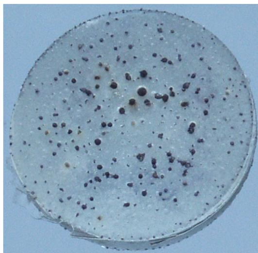
**Abb. 5.6-7:** Nachweis von primären Amingruppen im phasenseparierten Epoxidsystem nach 72 h Vernetzung an Luftfeuchte bei RT mithilfe von Ninhydrin: Die intensive blauviolette Färbung der Inklusionen sowie ihrer luftseitigen Umgebung belegt die Ausscheidung des Epoxidhärterers DETA (Foto; Hintergrund: Siliziumwafer, Probendurchmesser: 10 mm).
