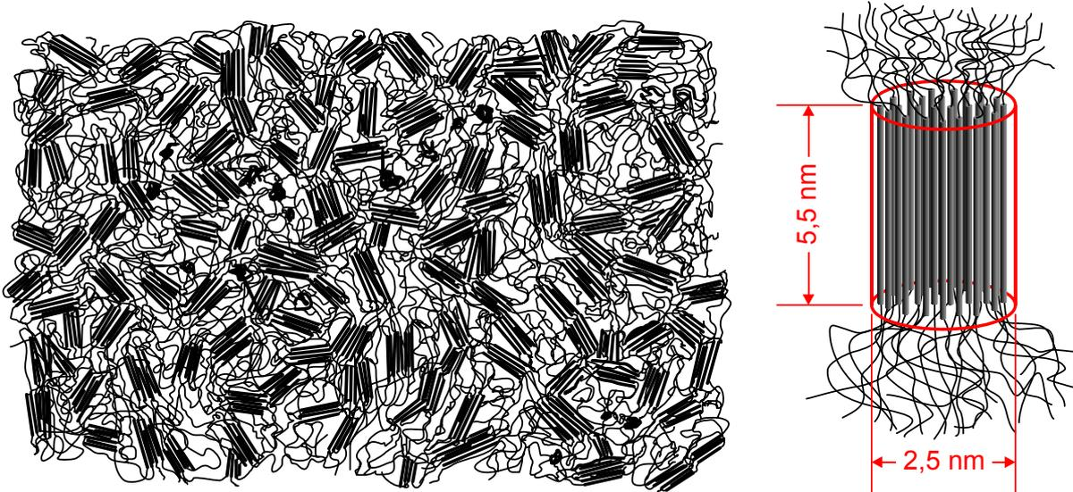
c) Phasenseparation (schematisch) in Form zylinderförmiger Domänen der Hartsegmente in einem thermoplastischen Polyurethan (Tertiärstruktur)
