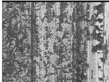
Bild 5.80: Verschleißspur eines Polyurethan-Nanokomposits mit 10 Gew.-% an 100 nm-800 nm großen Hämatit-Partikeln (E4) am Ende der Verschleißphase III nach 10.000 Zyklen.
