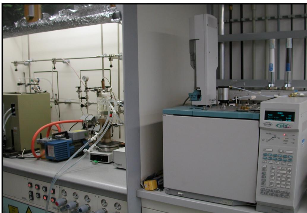
**Abbildung 3.2:** Reaktionsapparatur (links) mit Gaschromatograph (rechts)
