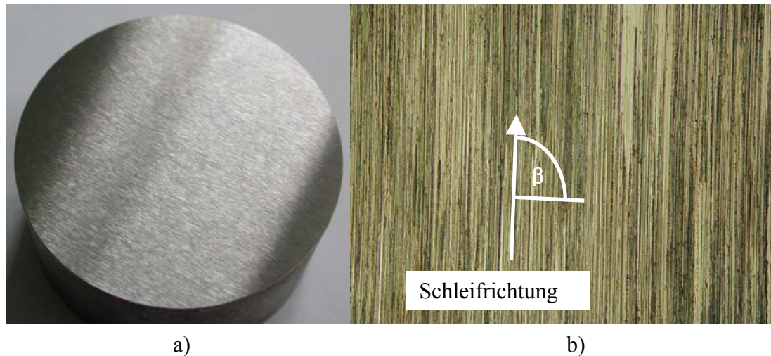
Abbildung 5-12: a) Schleifprobe b) 50fache Vergrößerung der Oberfläche
